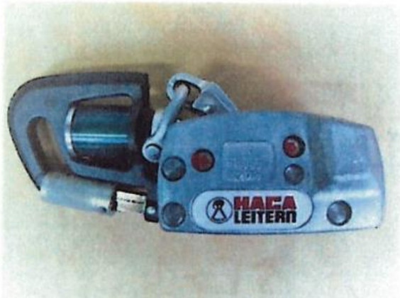
Zdjęcie 1 - 2: Urządzenie przeciwupadkowe samohamowne typu: 0529.74 oraz typu: 0529.74.30
